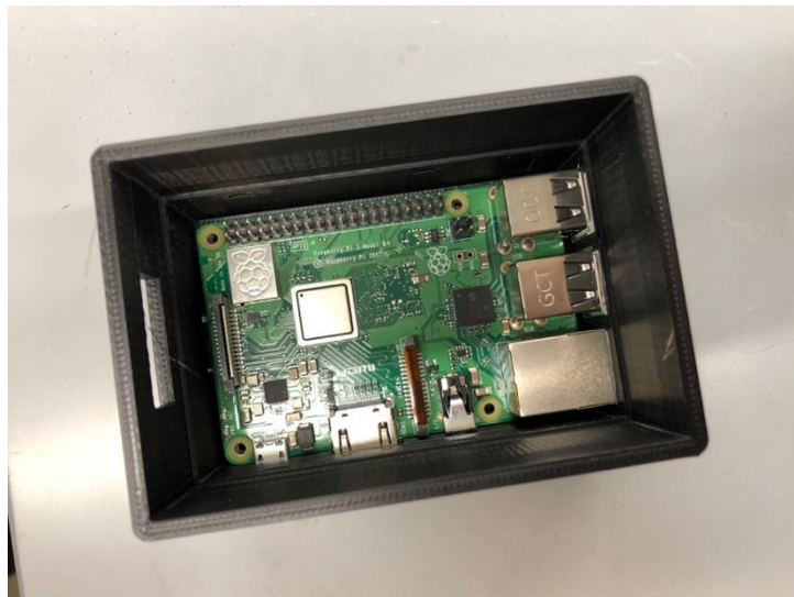
Figura 14: Inserção de Raspberry PI 4 no case
