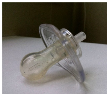
Figura 3 – Protótipo responsável por captar os movimentos da sucção, utilizado para o procedimento da pesquisa. Natal/RN. 2016 Fonte: Base Audição e Linguagem – LAIS/UFRN (2015).
