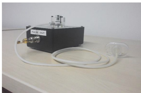
Figura 3 – Protótipo responsável por captar os movimentos da sucção, utilizado para o procedimento da pesquisa. Natal/RN. 2016 Fonte: Base Audição e Linguagem – LAIS/UFRN (2015).
